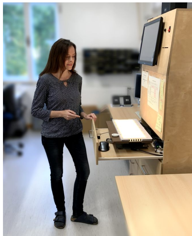
Abb. 3: 30 Prüfschritte durchläuft jede LED-Platine. Mischfarben werden dabei auf 0,25nm genau kalibriert.
