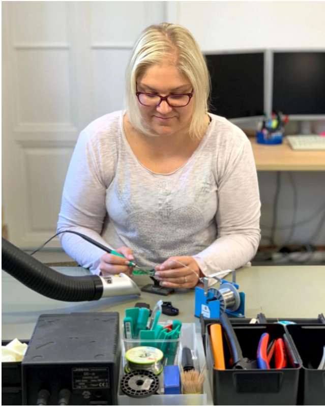
Abb. 2: Sandra beim manuellen Löten der Fernbedienung
